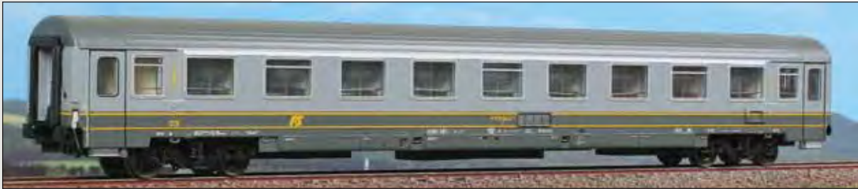
Vettura di 1ª classe FS Tipo Z, livrea di origine in due toni di grigio. Type Z 1 st class car of Italian Railways, two-tone gray livery. Typ Z 1. Klasse Wagen der italienischen Eisenbahnen, zweitönige graue Lackierung.
