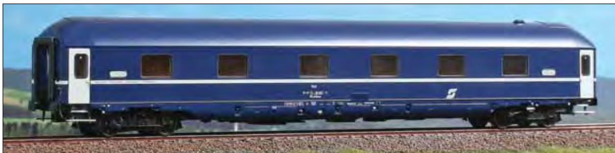
Carrozza letti WLABmz con carrelli München-Kassel, livrea blu con fasce e porte bianche. Sleeping car WLABmz with München-Kassel bogies, blu livery with white stripe on sides and white doors. Schlafwagen WLABmz mit München-Kassel-Drehgestellen, blaue Livree mit weißen Bändern und Türen.
