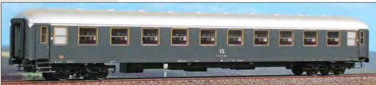
Carrozza FS di prima classe Tipo UIC-X 1968, livrea grigio ardesia e carrelli Minden FD. First class UIC-X 1968 type car of Italian Railways in slate gray livery and MD brake disc bogies. 1er Klasse Typ UIC-X 1968 Wagen der Italienschen Eisenbahnen in schiefergrauer Lackierung mit MD Drehgestellen.
