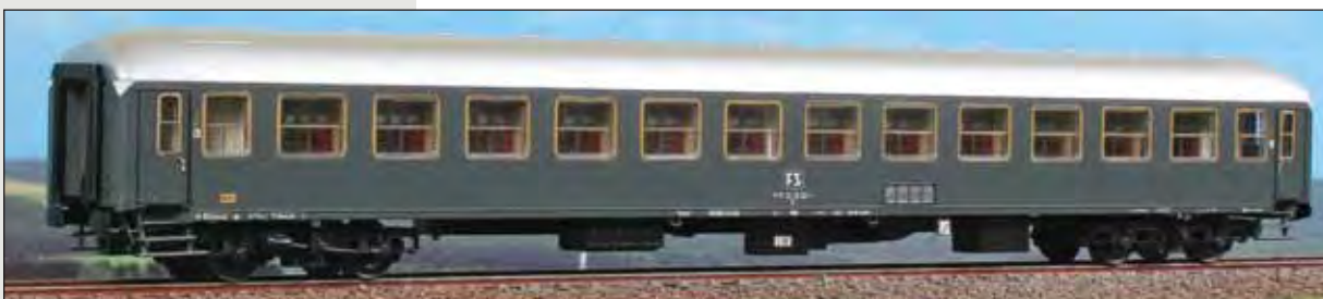
Carrozza FS di seconda classe Tipo X 1968, livrea grigio ardesia e carrelli Minden FD. Second class UIC-X 1968 type car of Italian Railways in slate gray livery and MD brake disc bogies. .2er Klasse Typ UIC-X 1968 Wagen der Italienschen Eisenbahnen in schiefergrauer Lackierung mit MD Drehgestellen.
