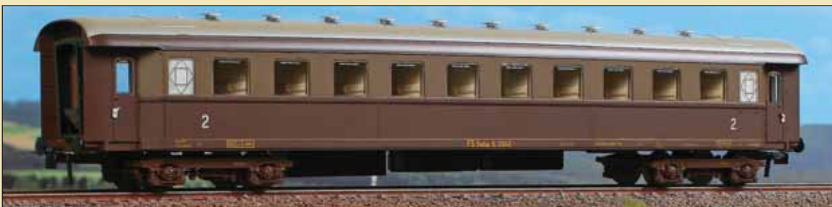
Carrozza di 2a classe Bz 33000 in livrea castano/Isabella con carrelli tipo 27, aeratori sul tetto, senza griglie laterali. 2 nd class car type Bz 33000 in two tone brown livery, type 27 bogies, roof aerators, without side grilles. Abteilwagen 2.Klasse Typ Bz 33000 in "castano/Isabella" Lackierung, Typ 27 Drehgestelle, Belüfter auf dem Dach, ohne Seitengitter.
