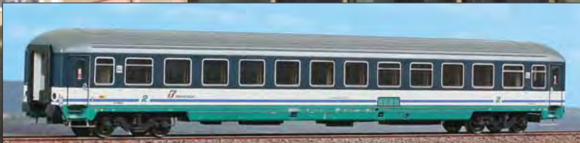
Carrozza di 2ª classe UIC-X "Giubileo" 1995R con porte a battente nella livrea Intercity Notte. 2 nd class car UIC-X "Giubileo" 1995R in the Intercity Notte livery. 2. Klasse Wagen UIC-X "Giubileo" 1995R in neuer Intercity Notte Lackierung.
