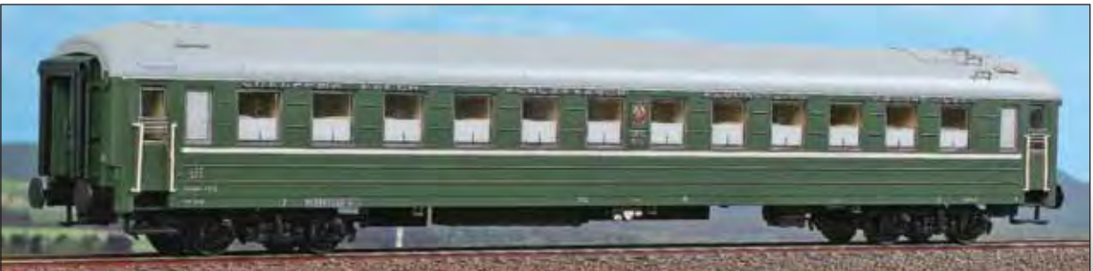
Carrozza letti SZD tipo 1957 con carrelli modificati, soffiotti in gomma, senza carenature Sleeping car SZD type 1957 with modified bogies, rubber transitions, without skirts Schlafwagen SZD type 1957 mit geänderten Drehgestellen, Gummiwulst-Übergängen, ohne Schürzen
