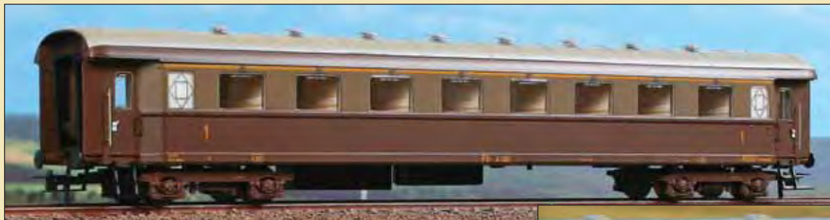
Carrozza di 1a classe Az 13000 in livrea castano/Isabella con carrelli tipo 27, aeratori sul tetto e griglie laterali. 1 st class car type Az 13000 in two tone brown livery, type 27 bogies, roof aerators and side grilles. Abteilwagen 1.Klasse Typ Az 13000 in "castano/Isabella" Lackierung, Typ 27 Drehgestelle, Belüfter auf dem Dach und Seitengitter.
