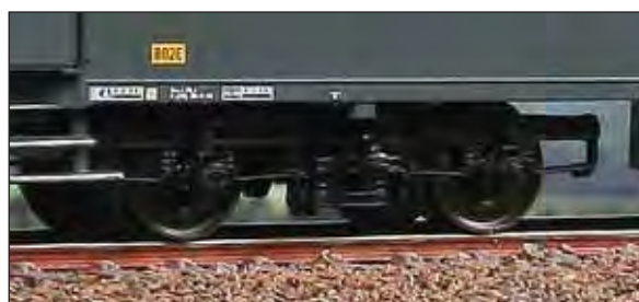
Carrozza FS di seconda classe Tipo X 1968, livrea grigio ardesia e carrelli Minden FD. Second class UIC-X 1968 type car of Italian Railways in slate gray livery and MD brake disc bogies. .2er Klasse Typ UIC-X 1968 Wagen der Italienschen Eisenbahnen in schiefergrauer Lackierung mit MD Drehgestellen.
