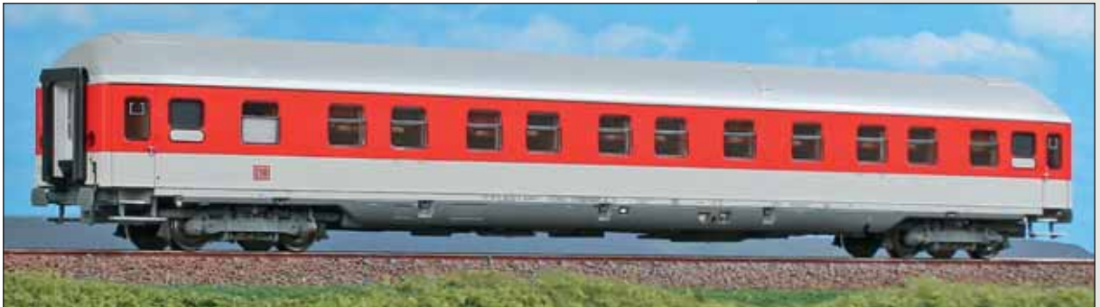
Carrozza letti WLABmh 174 con carrelli München-Kassel della DB AG, in livrea rossa e bianca. Sleeping car WLABmh 174 with München-Kassel bogies of DB AG, red and white livery. Schlafwagen WLABmh 174 mit München-Kassel-Drehgestellen der DB AG, rote un weiße Lackierung.
