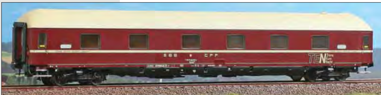
Carrozza letti WLABmh 174 con carrelli München-Kassel delle SBB, in livrea rossa. WLABmh 174 sleeping car of SBB with München-Kassel bogies, red livery. WLABmh 174 Schlafwagen der SBB, mit München-Kassel drehgestellen, rote Lackierung.
