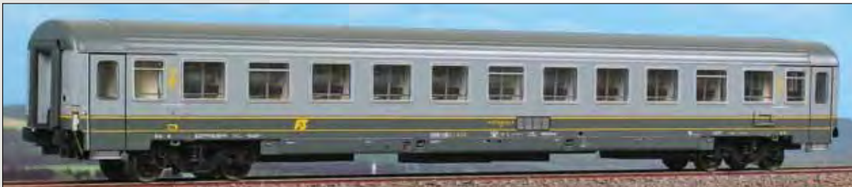
Vettura di 2ª classe FS Tipo Z, livrea di origine in due toni di grigio. Type Z 2 nd class car of Italian Railways, two-tone gray livery. Typ Z 2. Klasse Wagen der italienischen Eisenbahnen, zweitönige graue Lackierung.
