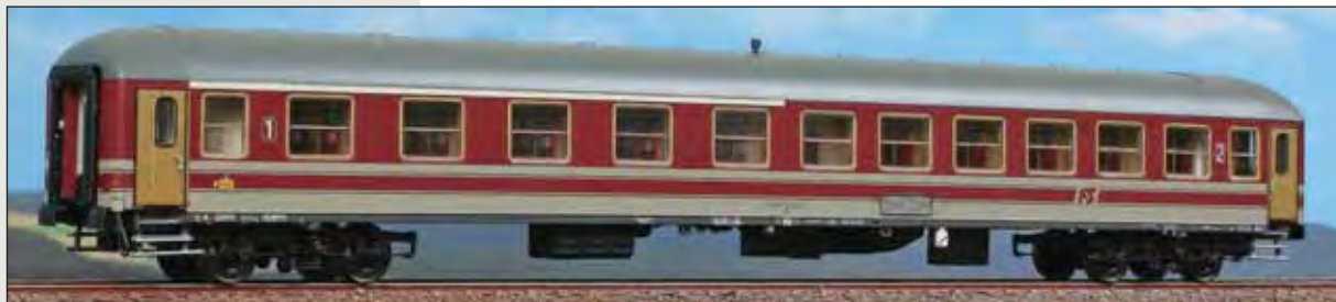
Carrozza Tipo X mista di prima e seconda classe per treni internazionale, livrea rosso fegato. Type X first and second class coach for international trains, beige and deep red livery. Typ X 1. / 2. Klasse-Wagen für internationale Züge, beige und leberrote Lackierung.
